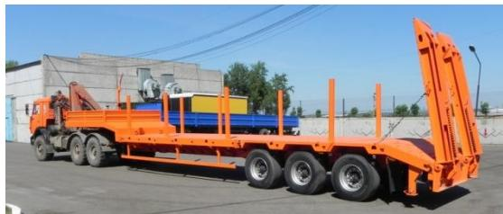
Трехосный тягач с осями НJ (аналог BPW), тормозная система – WABCO; на гусаке алюминиевая бортовая платформа высотой 600 мм.
