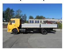
Алюминиевая бортовая платформа, стальной передний портал, задний откидной борт, настил пола — ламинированная влагостойкая фанера с противоскользящим покрытием толщиной 27 мм, утопленные кольца для фиксации груза — 8 шт. Внутренние размеры: 6125\*2480\*600 мм.
