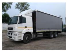
Алюминиевая бортовая платформа, стальной передний портал, сдвижные средние стойки, задние распашные ворота, тент. Шторный механизм, позволяющий производить загрузку через бока и крышу.
