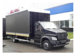
Алюминиевая бортовая платформа, стальной передний портал, быстросъемные средние стойки, задние распашные ворота, тент. Шторный механизм, позволяющий производить загрузку через бока и крышу.
