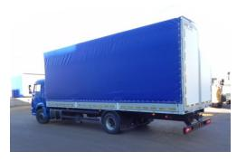
Алюминиевая бортовая платформа, стальной передний портал, быстросъемные средние стойки, задние распашные ворота, тент, настил пола — ламинированная влагостойкая фанера с противоскользящим покрытием толщиной 27 мм. Внутренние размеры: 7400\_7800\*2480\*2800 мм. Внут. объем: 55 куб. м.
