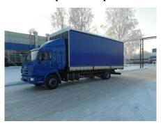
Алюминиевая бортовая платформа, стальной передний портал, сдвижные средние стойки, задние распашные ворота, тент, утопленные кольца для фиксации груза. Шторный механизм, загрузка через бока и крышу.
