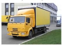
Алюминиевая бортовая платформа, стальной передний портал, сдвижные средние стойки, задние распашные ворота, тент, настил пола – ламинированная влагостойкая фанера с противоскользящим покрытием толщиной 27 мм, утопленные кольца для фиксации груза – 8 шт., «шторный» механизм, позволяющий производить загрузку как через бока, так и крышу. Внут. размеры: 6125\*2480\*2600 мм. Внут. объем: 40 куб. м.
