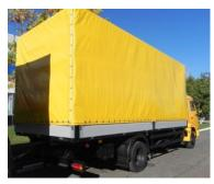
Алюминиевая бортовая платформа, стальной передний портал, быстросъемные средние стойки, задний откидной борт, тент, настил пола — ламинированная влагостойкая фанера с противоскользящим покрытием толщиной 27 мм, утопленные кольца для фиксации груза — 8 шт. Внут. размеры: 6125\*2480\*2600 мм. Внут. объем: 40 куб. м.
