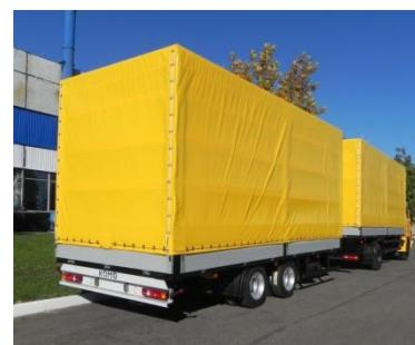
Алюминиевая бортовая платформа, стальной передний портал, быстросъемные средние стойки, задний откидной борт, тент, настил пола – влагостойкая фанера – 27мм, утопленные кольца для фиксации груза – 8шт.
