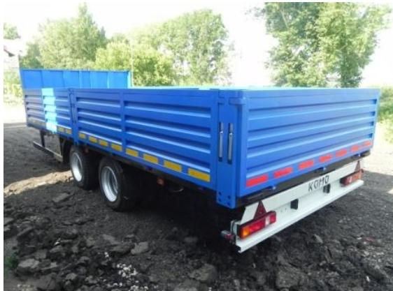
Стальная бортовая платформа с высотой бортов 730мм, стальной передний портал (возможны варианты изготовления по переднему борту), все стойки – съемные, настил пола – рифленая сталь или ламинированная влагостойкая фанера с противоскользящим покрытием толщиной 27мм, утопленные кольца для фиксации груза – 8шт.
