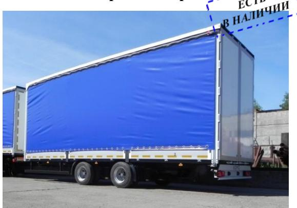
Алюминиевая бортовая платформа, стальной передний портал, сдвижные средние стойки, задние распашные ворота, тент, настил пола – влагостойкая фанера – 27мм, утопленные кольца для фиксации груза – 12шт.
