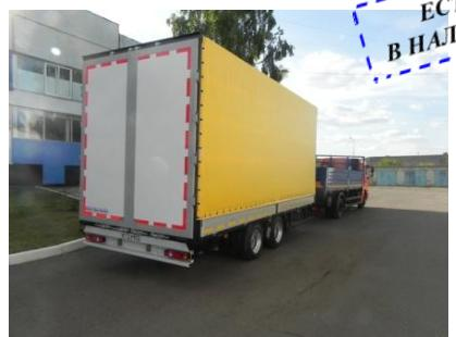
Алюминиевая бортовая платформа, стальной передний портал, быстросъемные средние стойки, задние распашные ворота, тент, настил пола – влагостойкая фанера – 27мм, утопленные кольца для фиксации груза – 8шт.
