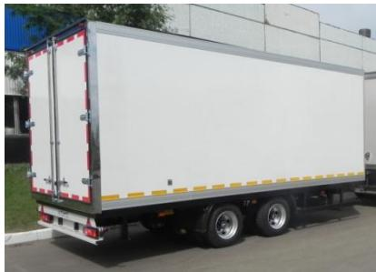
Промтоварный кузов прицепа выполнен из плакированного металла (цвет кузова и обвязки прицепа – на усмотрение клиента).
