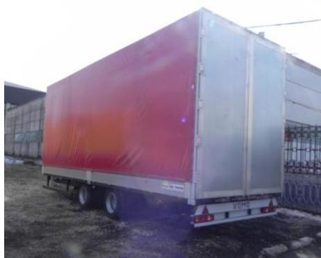
Алюминиевая бортовая платформа, стальной передний портал, быстросъемные средние стойки, задние распашные ворота, тент, настил пола – ламинированная влагостойкая фанера с противоскользящим покрытием толщиной 27мм, утопленные кольца для фиксации груза – 12шт.
