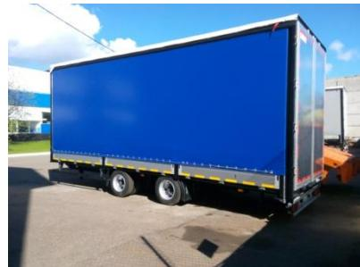
Алюминиевая бортовая платформа, стальной передний портал, сдвижные средние стойки, задние распашные ворота, тент, настил пола – влагостойкая фанера – 27мм, утопленные кольца для фиксации груза – 12шт. Шторный механизм (независимая загрузка через бока, так и крышу).
