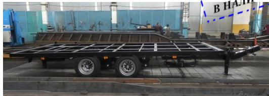
Усиленная рама, выполненная из специальной стали 09Г2С. Конструкция рамы обеспечивает погрузочную высоту 840мм. Прицепы данной серии выполняются на пневмо- подвеске с односкатной ошиновкой.
