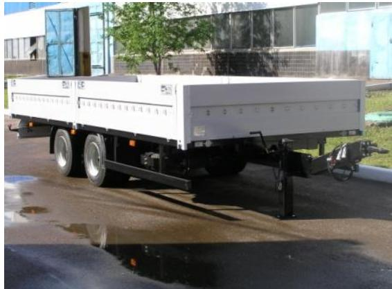
Алюминиевая бортовая платформа с высотой бортов 600мм (возможны варианты изготовления по переднему борту), все стойки – съемные, настил пола – рифленая сталь или ламинированная влагостойкая фанера с противоскользящим покрытием толщиной 27мм, утопленные кольца для фиксации груза – 8шт.
