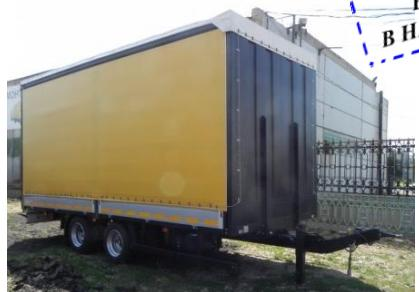
Алюминиевая бортовая платформа, стальной передний портал, сдвижные средние стойки, задние распашные ворота, тент, настил пола – влагостойкая фанера – 27мм, утопленные кольца для фиксации груза – 8шт. Шторный механизм (независимая загрузка через бока, так и крышу).
